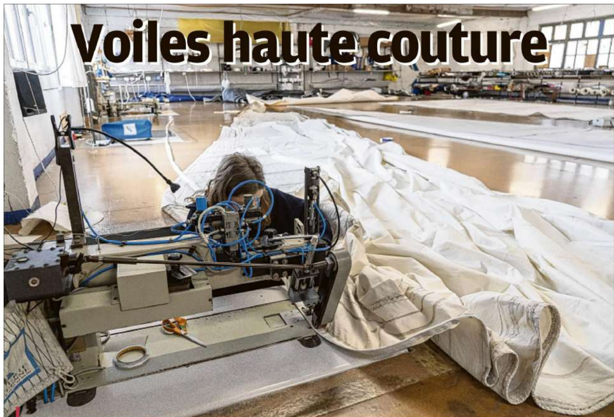
Installées dans des fosses qui placent leur regard et leur bras au niveau du sol, les couturières assemblent les laizes de tissus en utilisant un fil polyester traité anti-UV.
