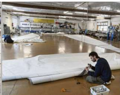
À gauche, l'étape cruciale des ultimes réglages et finitions. Au centre, l'atelier de gréement situé en sous-sol. À droite, la dalle de 400m 2 , parfaitement plane et propre, sur laquelle sont fabriquées les voiles.
